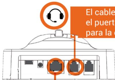
El cable telefónico debe estar conectado en el puerto de la base y en el puerto dedicado para la diadema.
