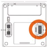
Puede que necesites ajustar el interruptor de cableado (ubicado debajo de la base) para encontrar la configuración adecuada.
